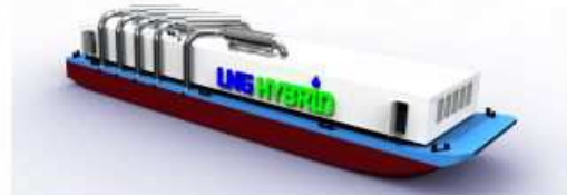
Fig. 3.9. Prototipo de barcaza suministradora de GNL (Fuente: GreenPort)
